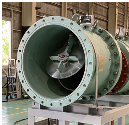
※真空逃がし弁とはPWR型原子炉鋼製格納容器に直接設置される弁です。格納容器真空逃がし装置は、通常運転時に格納容器スプレイが誤動作した際に、格納容器内が負圧となり許容負圧を下回らないように設置されており、大気を格納容器内に導入し格納容器を破損から守る安全装置です。
