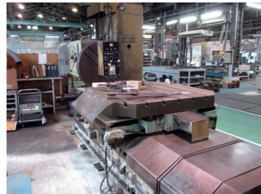
NCボーリング1号機面板式横中ぐり盤
