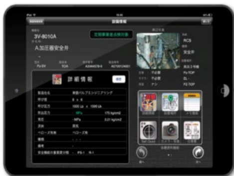
Omo10-VALVE (バルブ点検支援タブレット)
