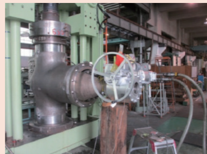
電動弁の作動漏洩試験
